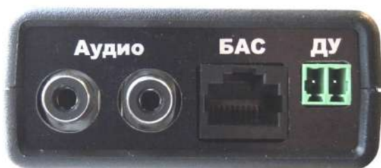
Рис. 2 Вид коммутационной панели модуля ММТ
