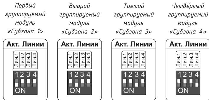
Рис. 2.5 Установка переключателей "Акт. Линии" при объединении блоков БУМ
