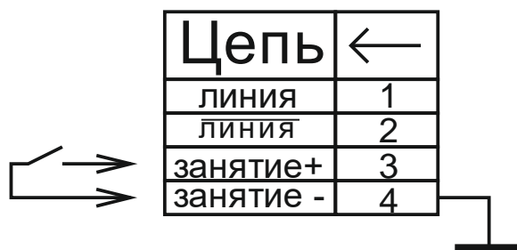
Рис. 1.9. Разводка разъема для подключения к линейному входу ГО.
