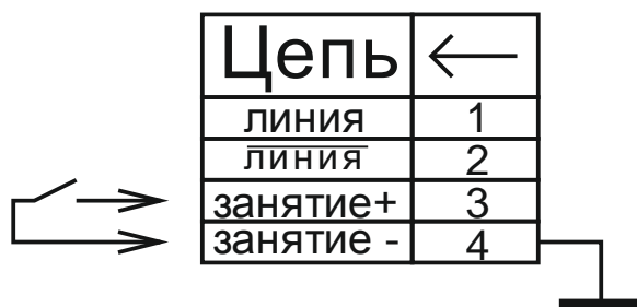
Рис. 1.15 Разводка разъема для подключения к линейному входу ГО
