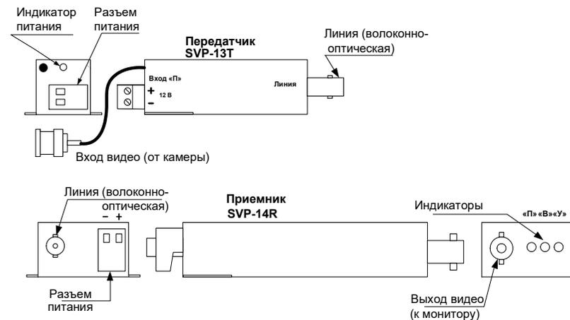
Рис. 1. Расположение разъемов и элементов индикации.
