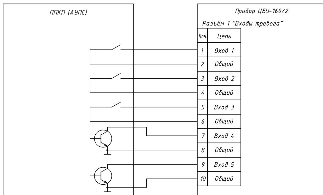
Рис. 1.2 Схема подключения ППКП (АУПС) к устройству
