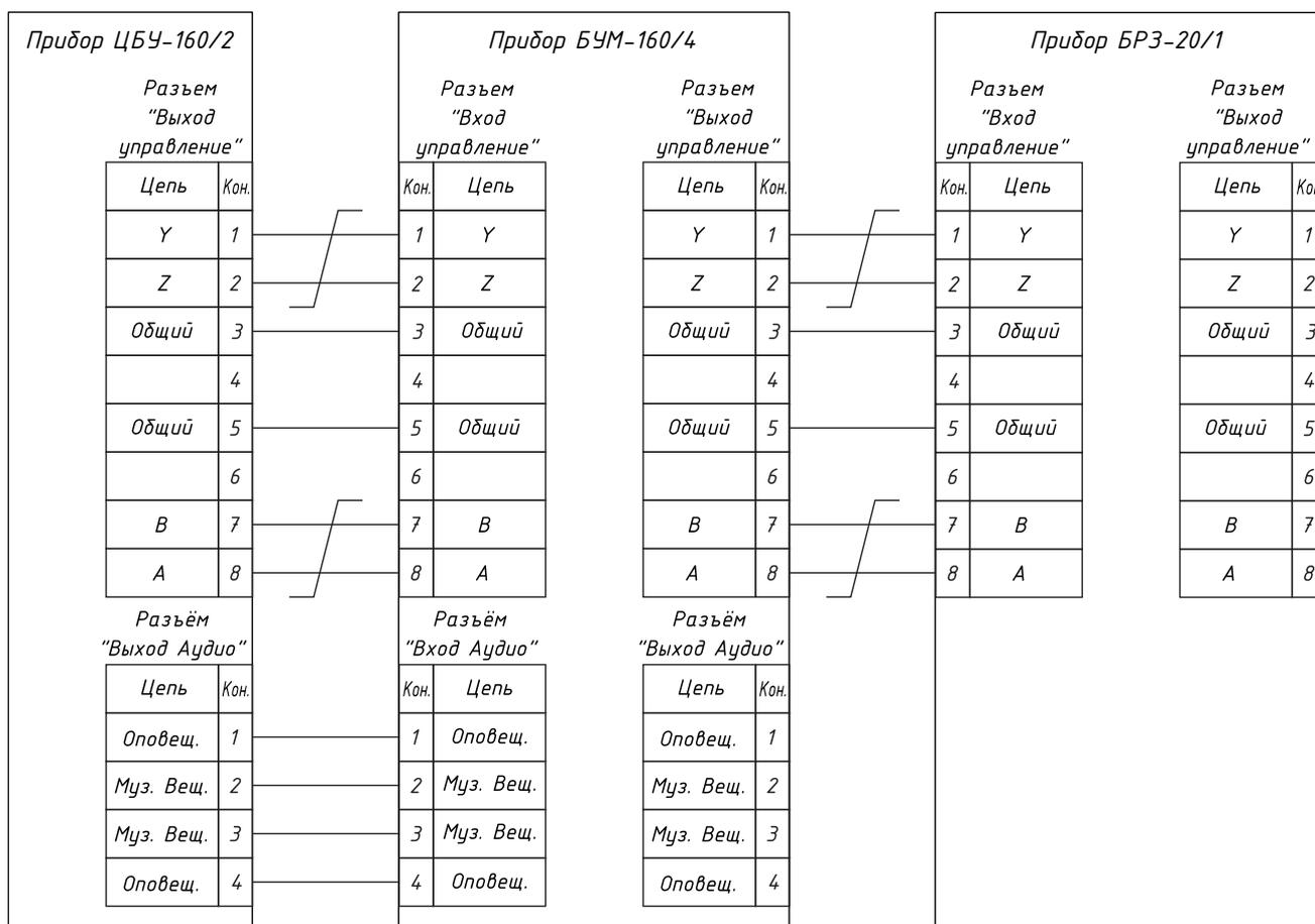
Рис. 1.4 Пример подключения устройства к блоку ЦБУ-160/2
