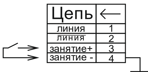
Рис. 1.15 Разводка разъема для подключения к линейному входу ГО
