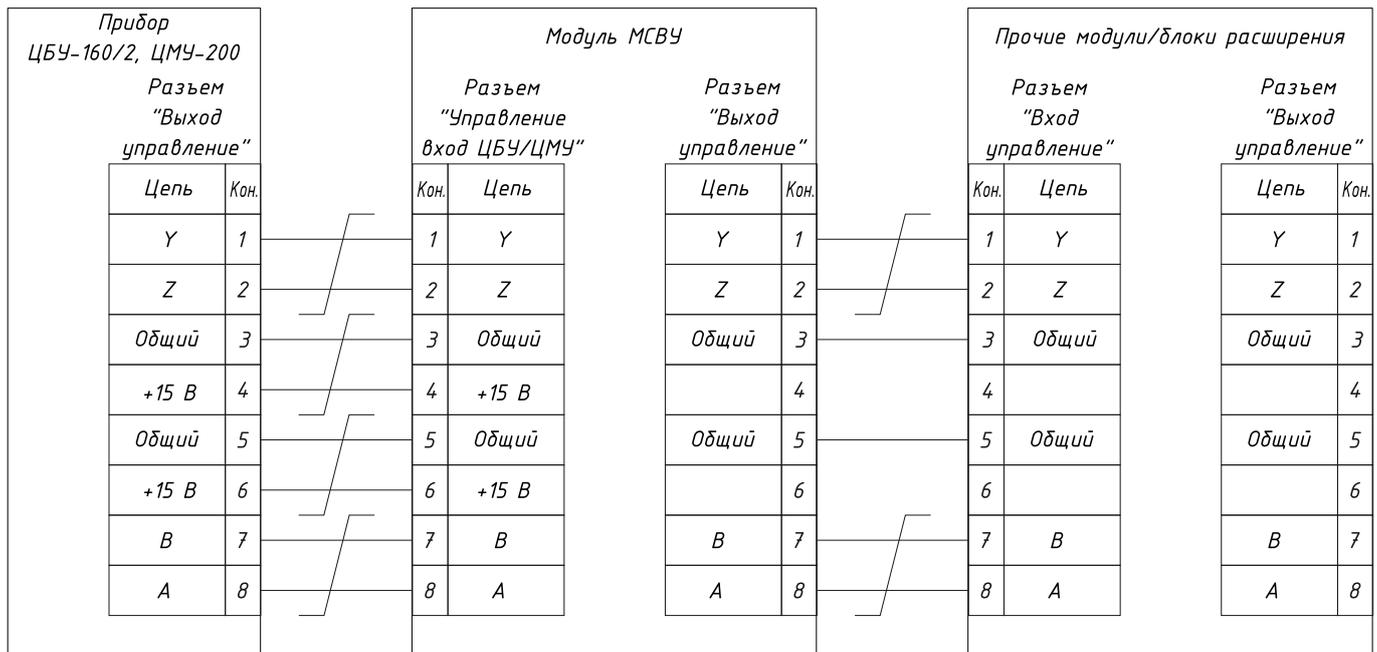
**Рис. 3 Взаимное соединение модулей**
