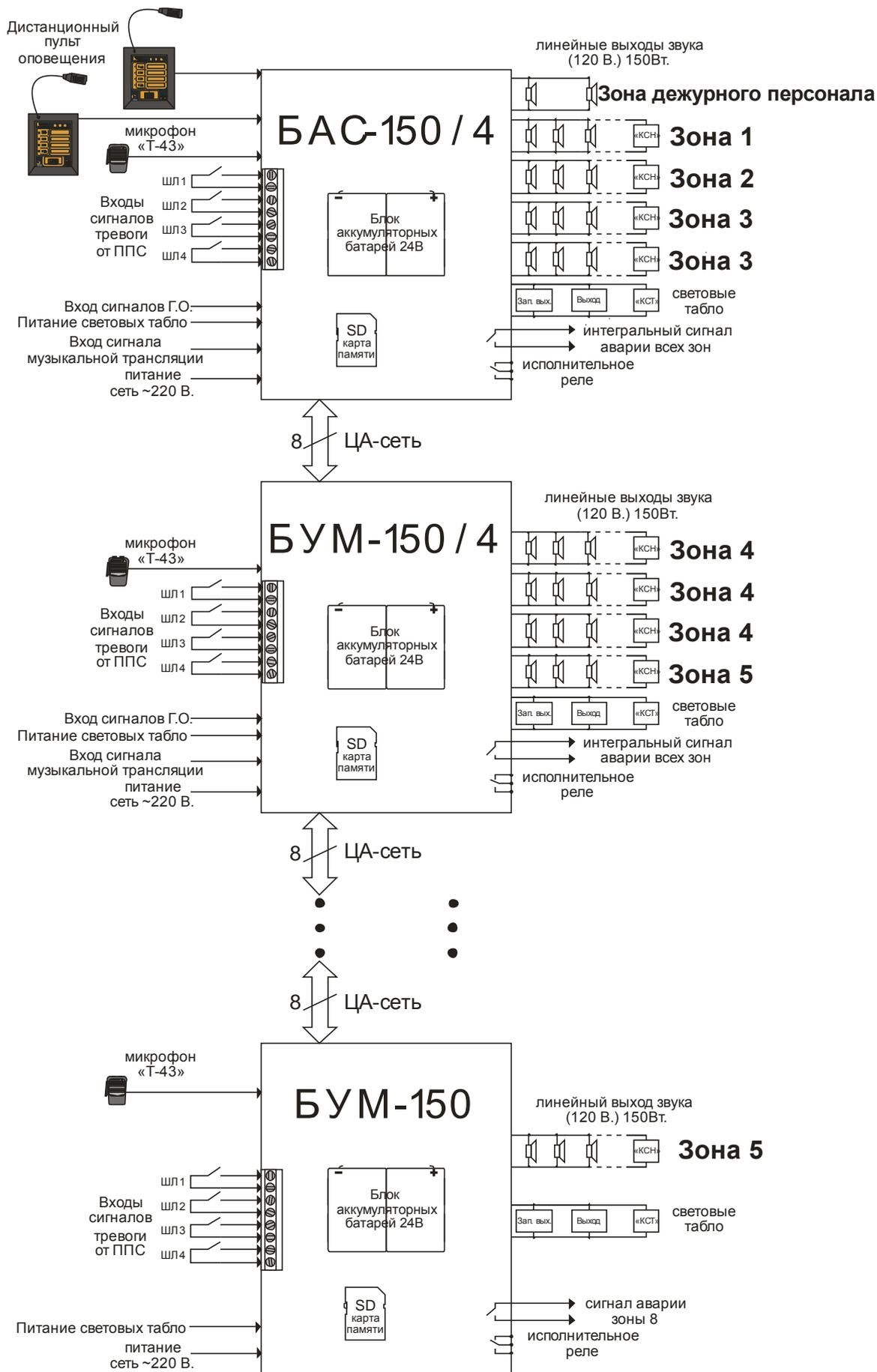
Рис. 1.2 Типовой вариант построения комплекса на базе БАС-150/4
