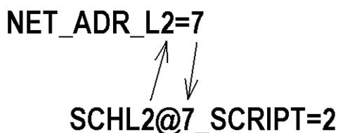
**Рис. 1.7** Связь между номером входа, номером линии и сетевым адресом
