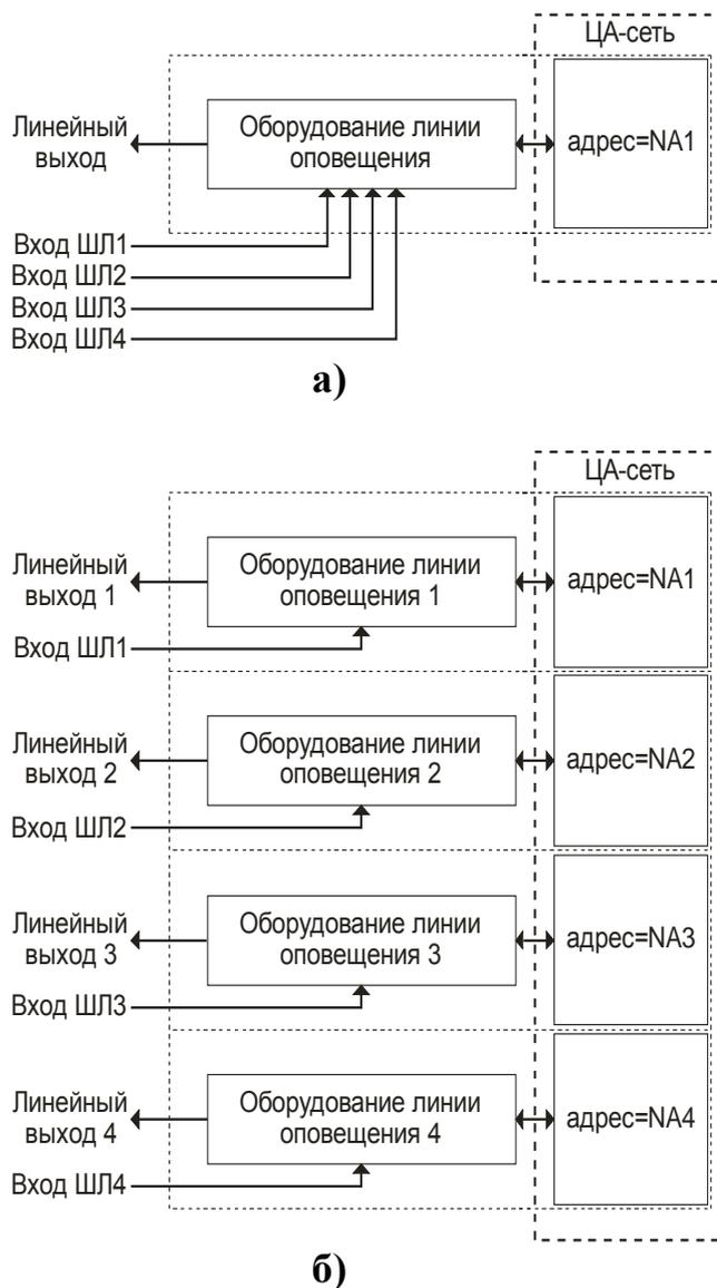
**Рис. 1.5 Информационные модели блоков БУМ-100, БУМ-150 (а) и БУМ-150/4 (б). Назначение всех входов – по умолчанию. Адреса NA1...NA4 выбираются из диапазона 1...63**
