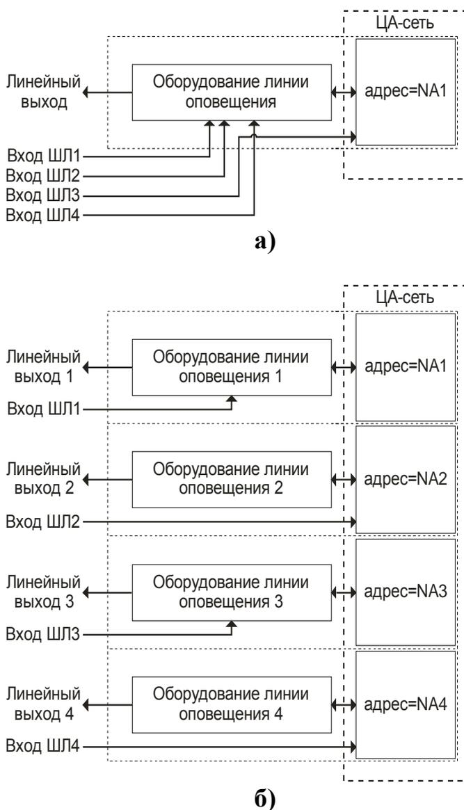
**Рис. 1.6** Информационные модели блоков БУМ-150 с одним (а), и БУМ-150/4 с двумя (б) системными входами. Адреса NA1...NA4 выбираются из диапазона 1...63
