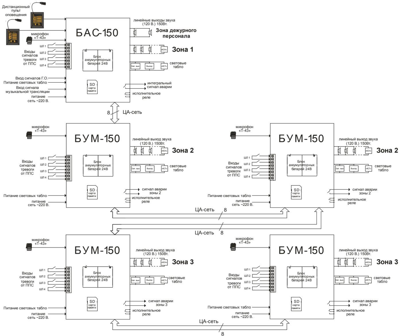
**Рис. 1.3 Использование составных зон для увеличения мощности сигнала оповещения**
